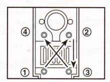
FOR BEST RESULTS, TIGHTEN ALL SCREWS INTO TILT PLATE IN NUMERICAL ORDER, MAKE SURE THEY ARE COMPLETELY TIGHTENED.
